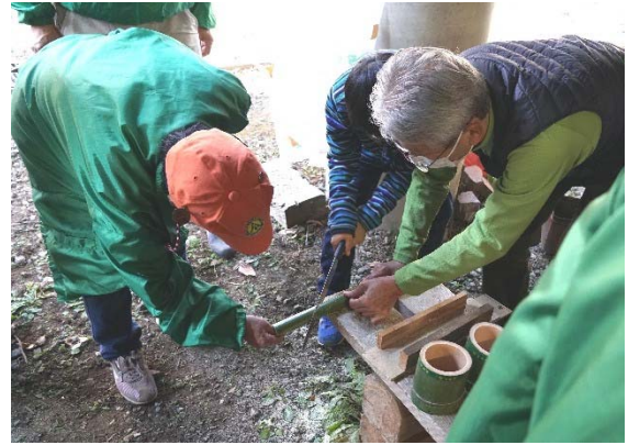
治具についた溝に沿って竹を斜めに切断
